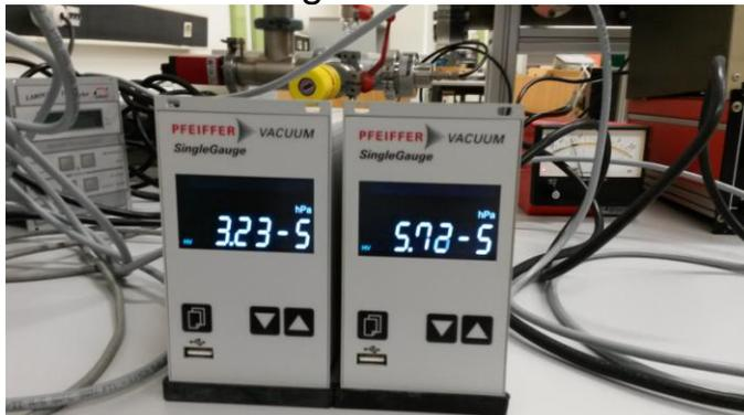
PKR 360, Compact Full Range Transmitter (Messgerät rot im Hintergrund)
