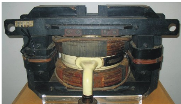
Abbildung 5: Historisches 6-MeV-Betatron (Deutschland 1942-46) und Schema der Funktionsweise.
