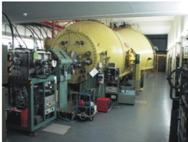
Abbildung 4: Elektrostatische Beschleuniger. Links: Cockroft-Walton-Generator als Vorbeschleuniger für Protonen (800 kV) am Paul-Scherrer-Institut (Schweiz). Rechts: Tandem-van-de-Graaff-Beschleuniger für Ionen am MPI für Kernphysik in Heidelberg (max. Hochspannung 12 MV, Ende 2012 stillgelegt).
