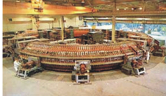
Abbildung 30: Links: schematische Darstellung der „schwachen“ Fokussierung. Dieser geometrische Effekt beruht darauf, dass sich zwei Kreisbahnen mit gleichem Radius einander annähern. Rechts das Cosmotron (BNL Upton/USA, 1952), eine Maschine ohne Quadrupolmagnete und entsprechend großer Ausdehnung des Strahls. Die Vakuumkammer war 32 Inch (81 cm) breit mit einer Wandstärke von 1 Inch.
