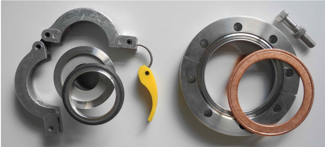
Abbildung 48: Vakuumflansche. Links: ISO-KF-Flansch DN 40 mit Rohransatz. Der Innendurchmesser des mit einem Elastomer-O-Ring versehenen Zentrierrings beträgt 40 mm. Der Spannring verbindet zwei gleichartige Flansche. Rechts: Schauglas mit CF-Flansch DN 63 und Kupferdichtung. Die Nennweite beträgt 63 mm, der Durchmesser des Lochkreises für acht M8-Schrauben ist 92,1 mm. Auf der gebrauchten Kupferdichtung ist der Abdruck der Schneidkante erkennbar.
