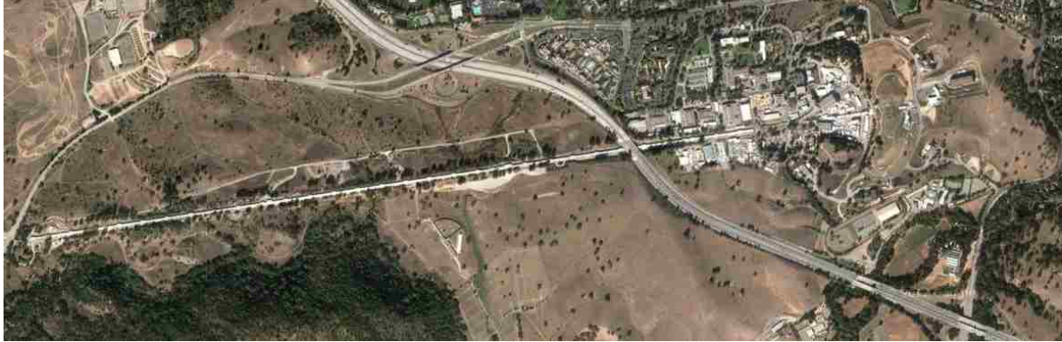
Abbildung 7: Der Zwei-Meilen-Linearbeschleuniger am SLAC (Menlo Park, USA) ist seit seiner Fertigstellung im Jahr 1966 bis heute der größte Linearbeschleuniger weltweit. Ursprünglich wurden Elektronen für fixed-target -Experimente auf 50 GeV beschleunigt. In den 1990er Jahren wurden Elektronen und Positronen aus demselben Beschleuniger durch zwei gegenläufige Bögen zur Kollision gebracht (SLAC Linear Collider, SLC). Von 1999 bis 2008 diente die Maschine als Injektor für die asymmetrische B-Mesonen-Fabrik PEP II. Seit 2009 wird das letzte Drittel genutzt, um Elektronen für den Freie-Elektronen-Laser LCLS auf 14 GeV zu beschleunigen.
