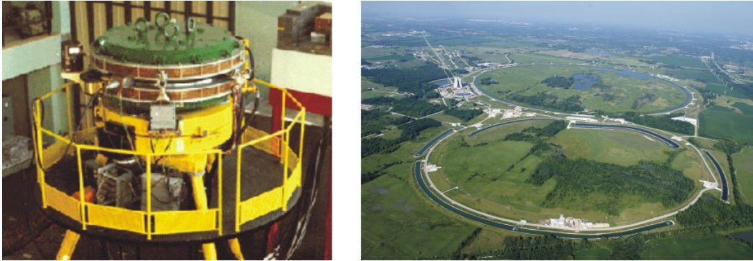
Abbildung 15: Zwei Speicherringe, links der weltweit erste e^+e^- -Speicherring AdA in Frascati/Italien (Strahlenergie 250 MeV), rechts der p\bar{p} -Speicherring Tevatron am Fermilab in Batavia/USA (980 GeV, 2011 abgeschaltet) mit dem sog. main injector im Vordergrund.
