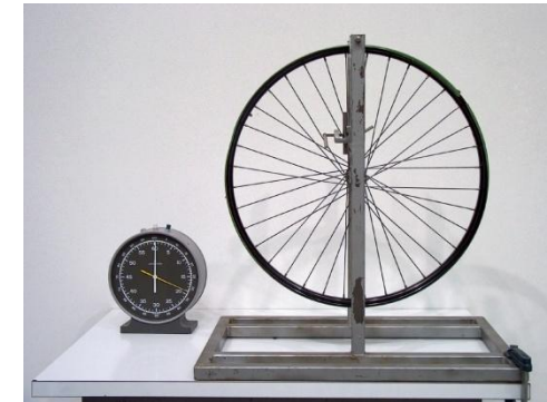
Das Reifenpendel schwingt um den Punkt am oberen Rand. Die Nabe kann entweder festgestellt oder lose sein.
