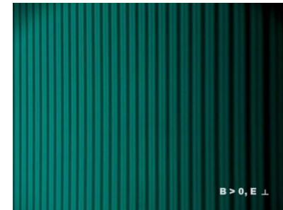
Magnetfeld \neq 0 , Polarisator 90^\circ
