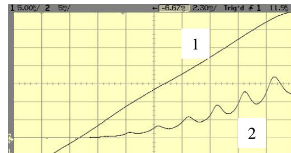
Oszillograf: 1. Beschleunigungsspannung 2. Elektronenstrom
