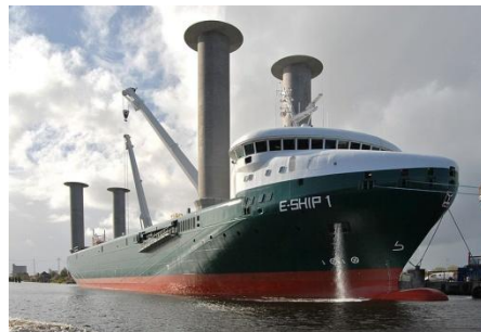
Experimentelles Frachtschiff mit Flettner-Rotoren zur Treibstoffersparnis.
