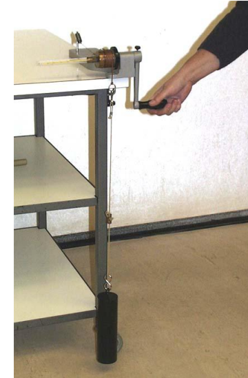
Bestimmung des mechanischen Wärmeäquivalents s. Übungsblatt 6
