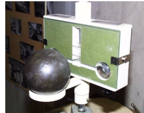
Gravitationsdrehwaage: Je eine große und eine kleine Kugel ziehen sich an, wobei im Wesentlichen die kleinen Kugeln an den Enden einer drehbaren Stange beschleunigt werden. Die Drehbewegung wird über einen Spiegel mit einem Laserstrahl angezeigt.
