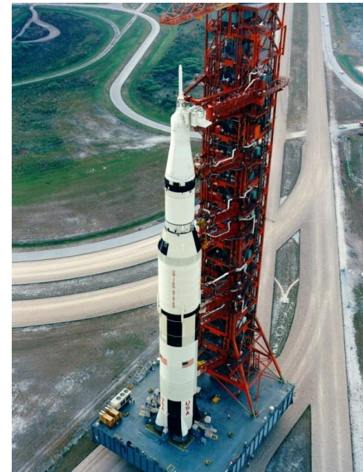
Die Saturn V ist eine dreistufige Rakete, die 1969 bis 1972 für bemannt Mondflüge verwendet wurde (Höhe 111 m, Masse 2935 t)
